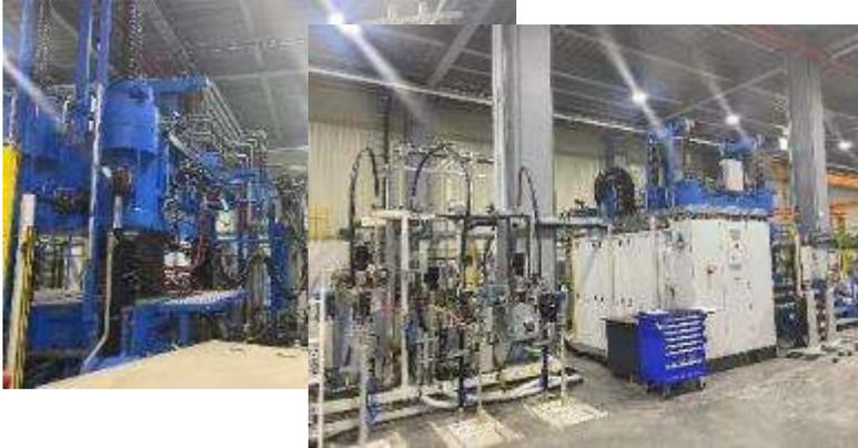
HP-RTM (全台唯一/超高壓灌注機)
